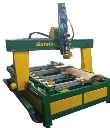
4х осевой ЧПУ станок с подвижными траверсами и вакуумными присосками \ пневмоприжимами
